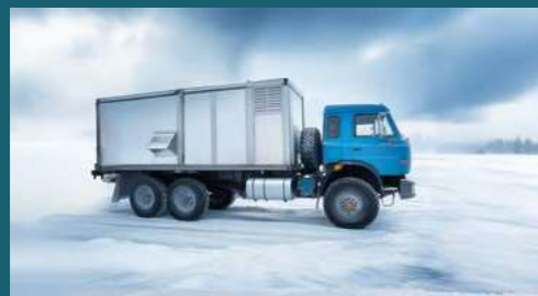
Передвижная ДЭС на базе КАМАЗ
